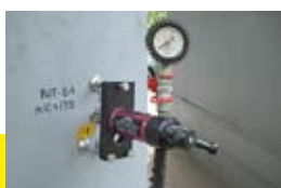
Натурные испытания на объекте (шпилька M10x135, установка в колонну из тяжелого бетона, максимальная нагрузка на вырыв 30,7 кН)
